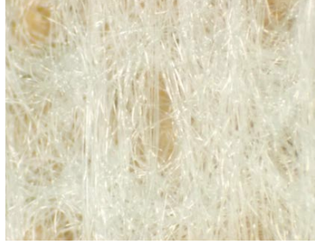
不織布顕微鏡写真(30倍)
